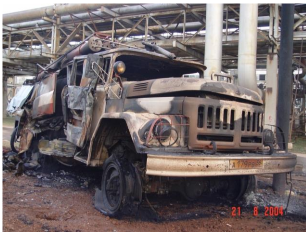
Рисунок 1 - Знищений пожежний автомобіль в результаті викиду та горіння нафтопродукту
