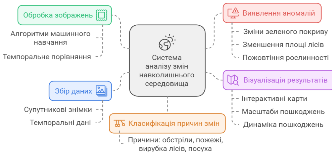
Рисунок 1 – Блок схема системи аналізу змін навколишнього середовища
