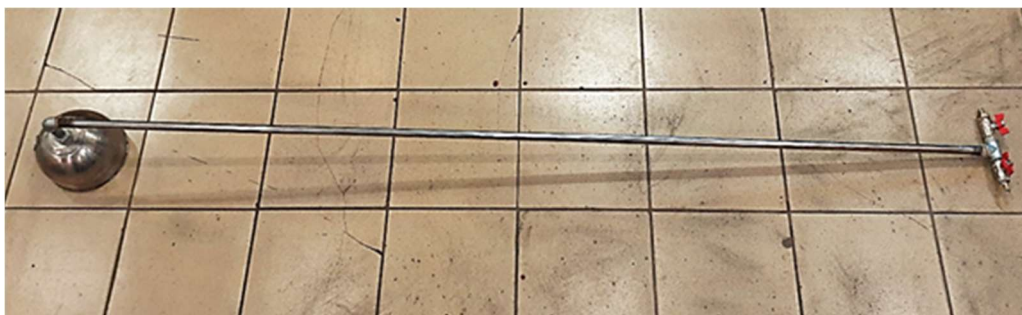
Рисунок 1 – Загальний вигляд насадки «заспокоювача» та труби-подовжувача із запірними вентилями
