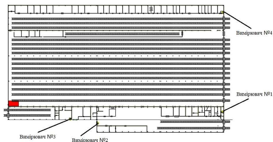
Рисунок 4 – Розташування датчиків вимірювання небезпечних чинників пожежі
