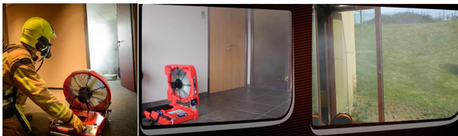
Рисунок 4 – Нагнітання свіжого повітря в задимлене приміщення
