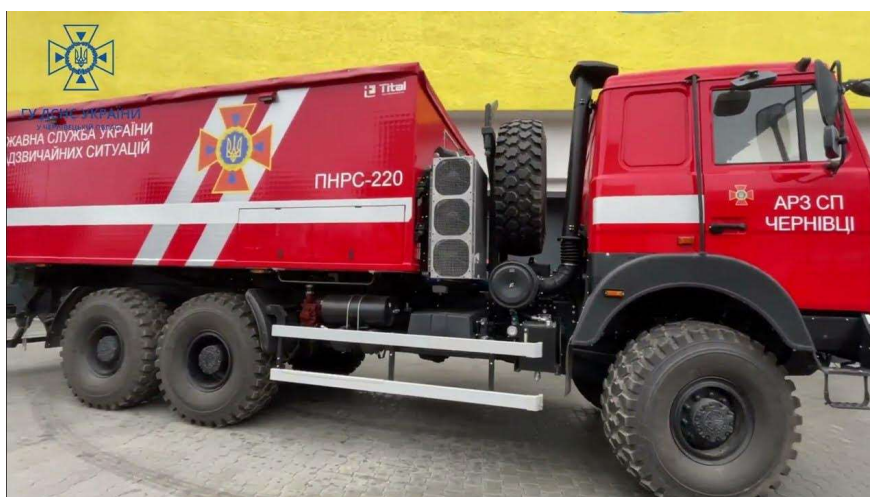
Рисунок 3 – Пожежна насосно-рукавна станція ПНРС 220/800 6317 F9
